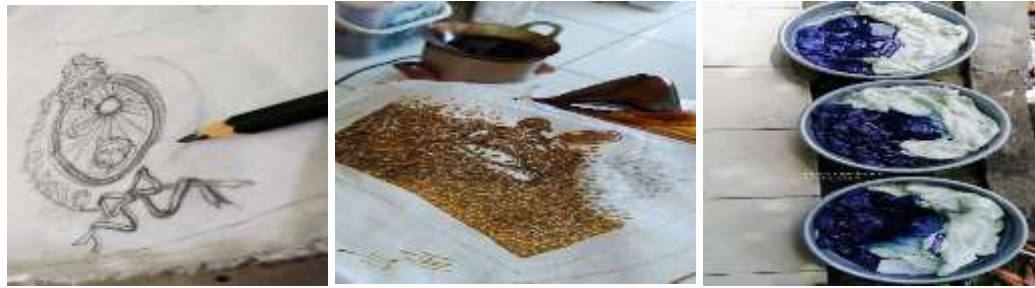
Gambar 1. Proses Menggambar Pola, Proses Pencantingan, dan Proses Pencelupan sebelum Pelaksanaan Kegiatan Pengabdian
